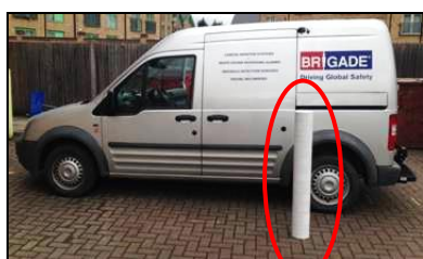
1 m lange paal onder een camera die op een hoogte van 1,8 m is bevestigd
